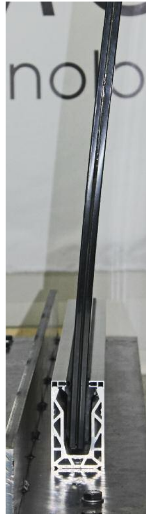
Déformation à 4,5 kN/m de poussée
