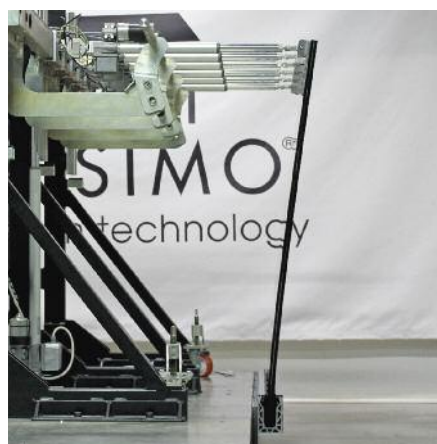
Déformation à 3 kN/m de poussée
