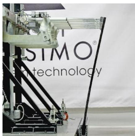
Déformation à 4,8 kN/m de poussée
