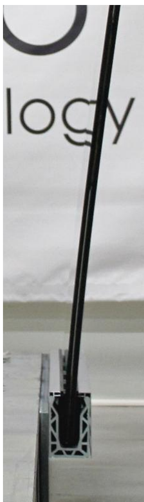
Déformation à 3 kN/m de poussée
