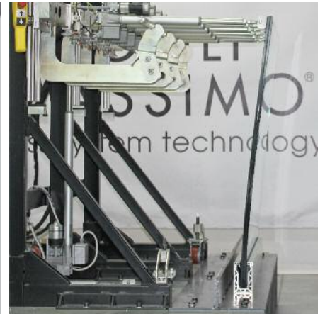
Déformation à 3 kN/m de poussée
